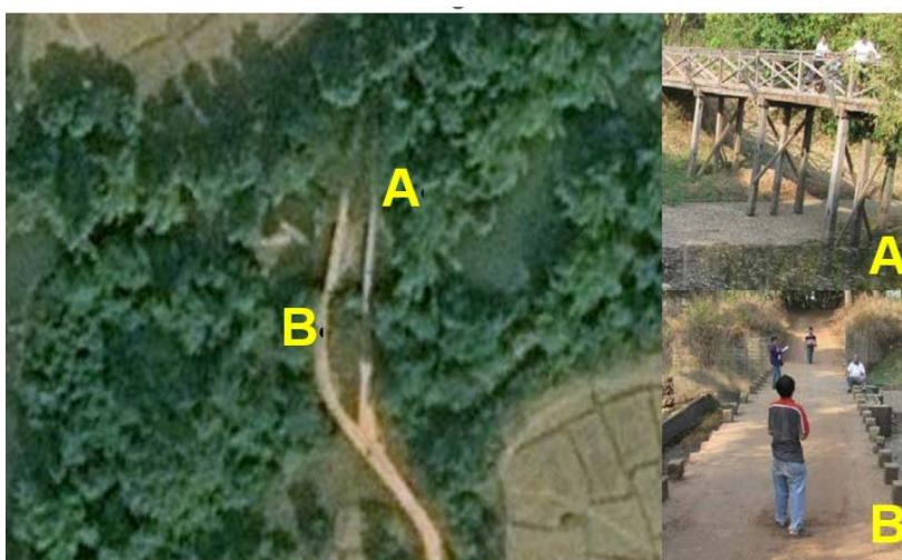
ภาพที่ 12 การประเมินภาคสนามของโครงสร้างที่คาดว่าจะเป็นสิ่งขวางกั้นลำน้ำจำนวน 2 แห่งที่ระบุจากขั้นตอนที่ 1 โครงสร้าง A เป็นสะพานและไม่ใช่สิ่งขวางกั้นลำน้ำ ในขณะที่โครงสร้าง B ถูกประเมินว่าเป็นสิ่งขวางกั้นลำน้ำ และต้องทำการวัดขนาดเพิ่มเติม
